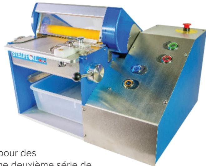
La Stripfoil Moto est équipée de paramétrages simples pour des blisters aux alvéoles espacées de manière régulière. Une deuxième série de disques à réglage manuel permet la déblisterisation des plaquettes irrégulières ou celles avec un écartement important. L'axe soutenant les roues est démontable pour faciliter le nettoyage.
